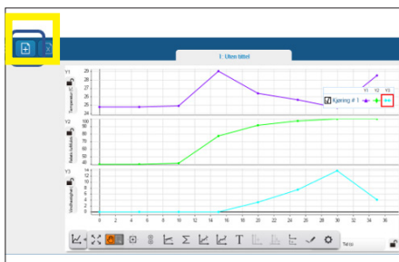
Koble til Værsensoren (husk å slå den på først) Velg de parametre du vil måle velg Graf og måleintervall 5 s
